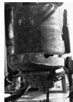
F19. Holte eccentric underreamer bit, p. 91.
