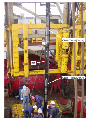
F17. Borehole seismometer instrument package, p. 49.
